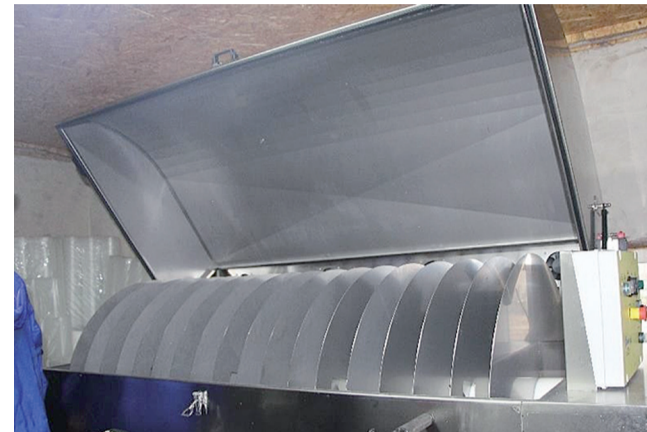
Техника для сушки больших объемов меда с подогревом до 37°C. За сутки из 1 т меда убирает 2–3% влаги
