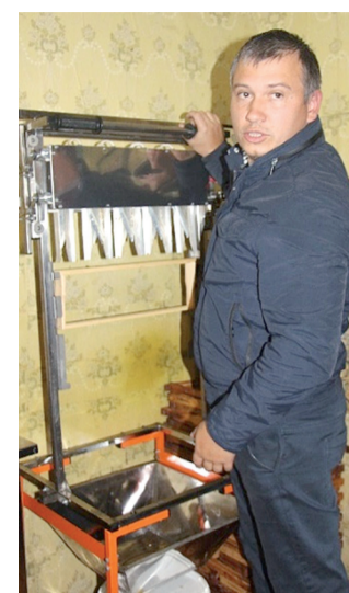
Станок для распечатывания магазинных рамок с сотами со срезывающими ножами держит температуру 40-70°C
