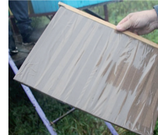
Заставная пенополистирольная доска, обмотанная скотчем, имеет преимущество по цене, легкости и скорости изготовления
